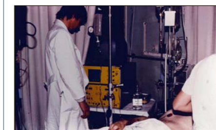
Prototype du calculateur numérique estimant les paramètres hémodynamiques et respiratoires du patient.
