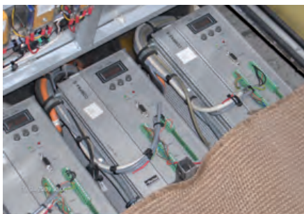
Vue des contrôleurs PID + Modèle Type HAUSER CPX2 avec carte d'entrée analogique E9 embarqués dans le coffre à bagages du Mooney.
