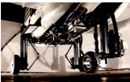
Vue de dessous de la carlingue et de ses 3 actionneurs dans une configuration d'entretien, totalement levée.
