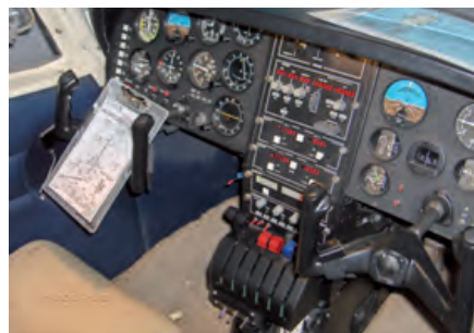
Vue du cockpit avec instruments de bords : tout est d'origine mais a fait l'objet d'adaptations pour retranscrire la réalité effective du vol.
