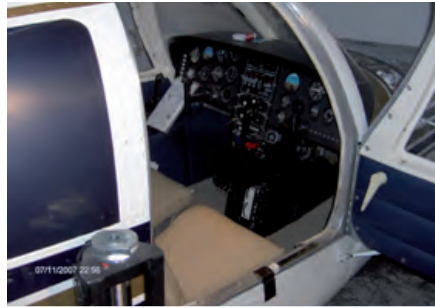
«Bienvenue à bord...»: tous les instruments de vols sont asservis via moteurs pas à pas tels que la situation de vol l'impose... pas loin de 2000 [h] de travail !
