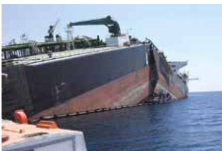
Rupture de Type « fragile » de la coque d'un tanker. Source : www.marineinsight.com , Fiveoceansalvage/H. SAAD, 2014, «Why Do Ship's Hull Fail At Midship Region?».
