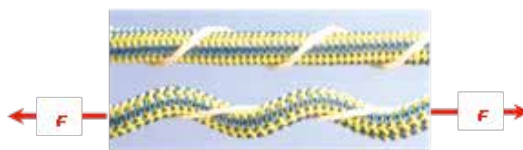
Illustration de technologies dites auxétiques: sous charge axiale F, la corde extérieure se tend, provoquant la contraction du noyau central.
